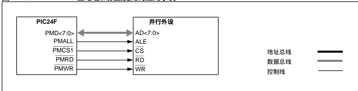
图 17-9 : 8 位地址和数据复用的应用示例
