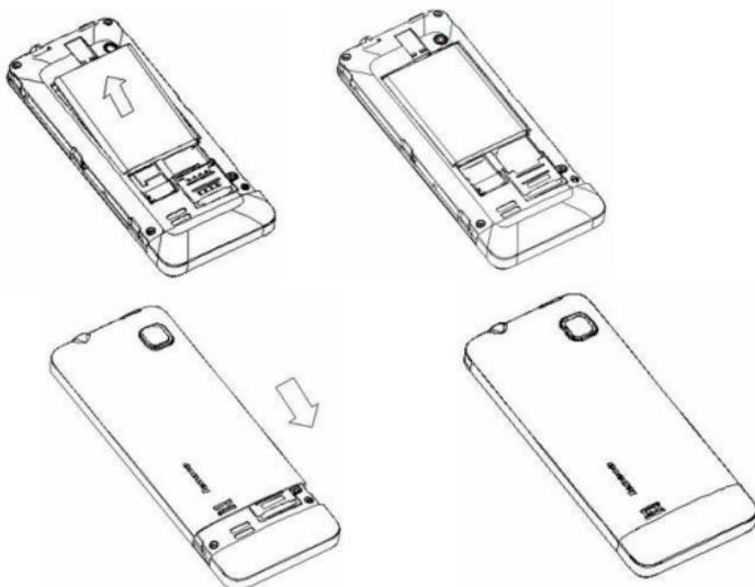
**警告：**拆卸电池之前一定要将手机关机并移去外部电源。绝对禁止在开机的情况下直接取出电池，否则可能损坏 SIM 卡和手机。
