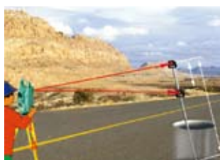
方便获取不能直接测量的点坐标
