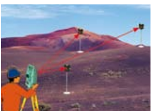
快速获取测站点的高程数据
