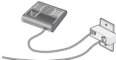
**2** 将您的电信设备直接连接在打印机后面的 EXT (电话分机) 插口 上。
