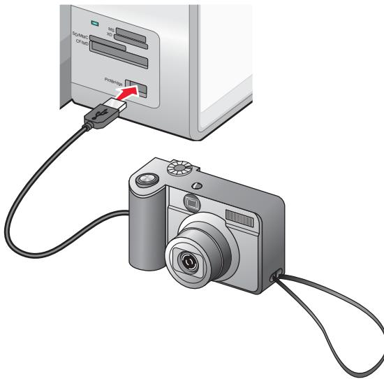
**警告:** 当正在从 PictBridge 兼容数码相机中打印时, 请不要触摸 USB 电缆、任何网络适配器或图中所示的打印机区域, 否则可能会发生数据丢失。另外, 当正在从 PictBridge 兼容数码相机中打印时, 请不要断开 USB 电缆或网络适配器。
