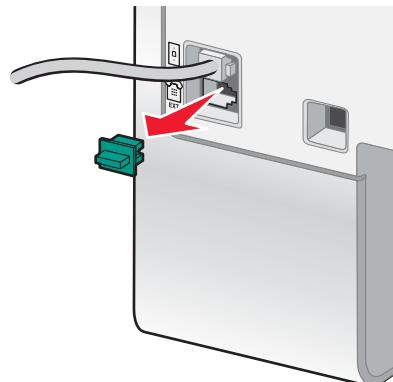
**4** 使用第二根电话线连接电话机和计算机调制解调器。
