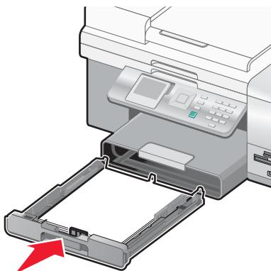
**注意:** 如果您拉开了托盘以容纳 A4 或 Legal 尺寸的纸张, 托盘将无法完全插入打印机内。请不要尝试用力将托盘向里推。
