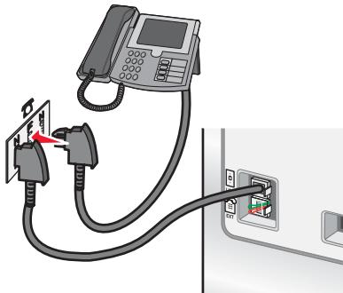
**5** 如果您希望使用同一电话线路在您的电话答录机上记录信息，请使用第二根电话线（未提供）连接电话答录机和墙壁电话线插座的另一个 N 插口。
