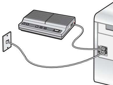
**注意：**当去掉保护塞后，您通过适配器连接在打印机上的任何国家 / 地区的设备（如图所示）都将不能正常工作。
