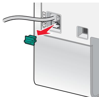
**4** 使用另一根电话线连接电话机和打印机后面的 EXT (电话分机) 插口
