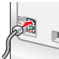
**3** 将电话线的另一端连接在可用的墙壁电话线插座的 N 插口上。
