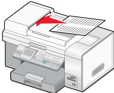
**注意：**请不要在自动文档传送器内装入明信片、照片、较小的物体或较薄的介质（例如杂志剪辑）。请将这些物体放置在扫描仪玻璃上。
