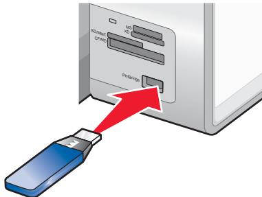
**注意：**如果您的蓝牙适配器无法直接插入插口中，则需要使用一根转换电缆。
