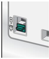
**注意:** 请不要去掉保护塞。如果您去掉了保护塞, 您家中其他的电信设备(例如电话机或电话答录机)可能无法正常工作。
