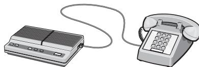
**5** 使用第三根电话线连接电话答录机和打印机后面的 EXT (电话分机) 插口
