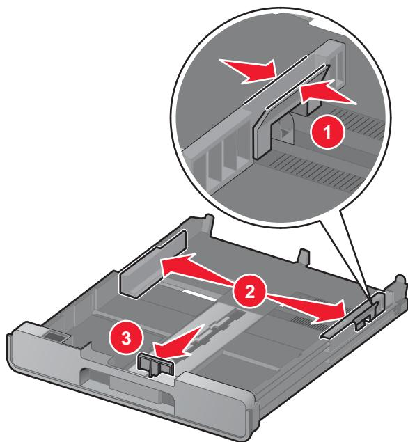
**注意：**如果您要装入 A4 或 Legal 尺寸的纸张，请按下锁定按钮，然后向外拉开托盘。对于长度小于 A4 或 Legal 尺寸的纸张（例如 Letter 尺寸的纸张），您不需要拉开托盘。当您向外拉开托盘时，第一个固定位置适合于 A4 尺寸的纸张。当托盘完全拉出时，适合于 Legal 尺寸的纸张。
