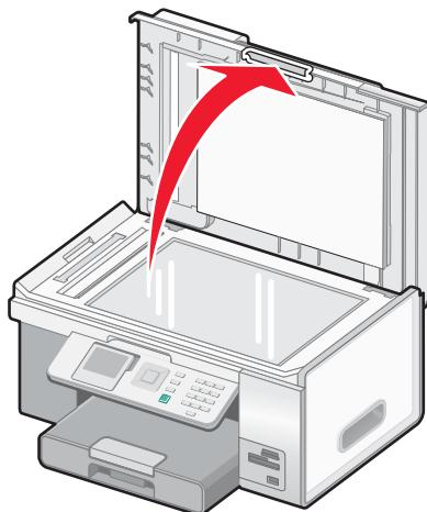
**3** 将文档原件或物体正面朝下放置在扫描仪玻璃的左上角。此角落周围的箭头将会提示您正确的位置。
