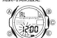
1. 顯示鬧鈴功能畫面後，按住 (A) 鈕直至鬧鈴時間的時數位開始在畫面中閃動。此表示現已進入設定畫面。
