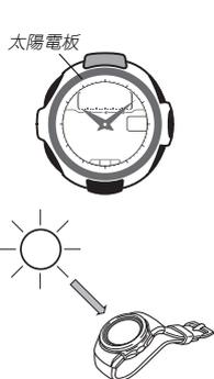
本錶裝備有太陽電板及一個蓄電池(二次電池)。蓄電池可儲存由太陽電板所產生的電能。下圖是在充電時如何放置手錶的說明。
