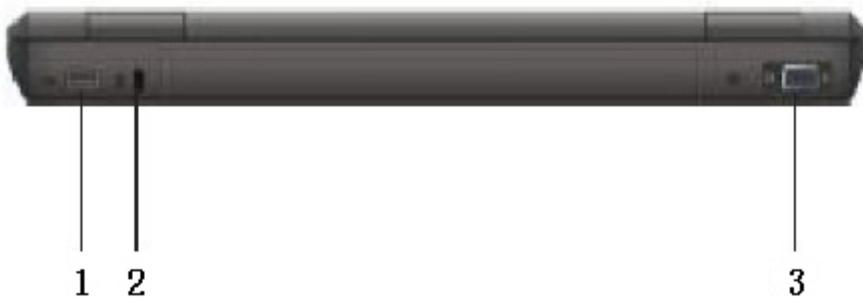
1. **USB端口** 连接USB设备，例如打印机、数码相机、游戏摇杆等。
