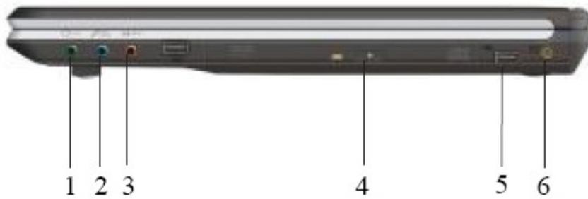
1. **音频输出接口** 音频输出，可连接耳机、喇叭或扩音设备。
