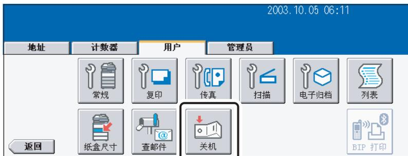
**3** “正在进行的作业将被删除，你确定要关机吗？”将显示在屏幕上。按 [ 是 ] 键。
