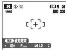
当主体亮度超出相机的亮度测量范围时，光圈设置显示为“F---”。此时，请半按快门按钮重新测量亮度。
