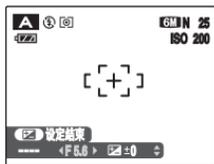
当主体亮度超出相机的亮度测量范围时，快门速度显示为“---”。此时，请半按快门按钮重新测量亮度。
