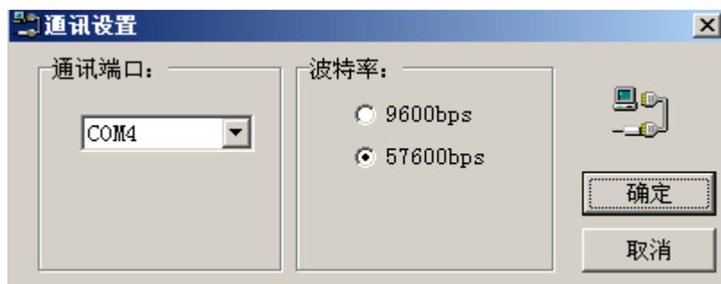
图 6-1 通讯端口设置
