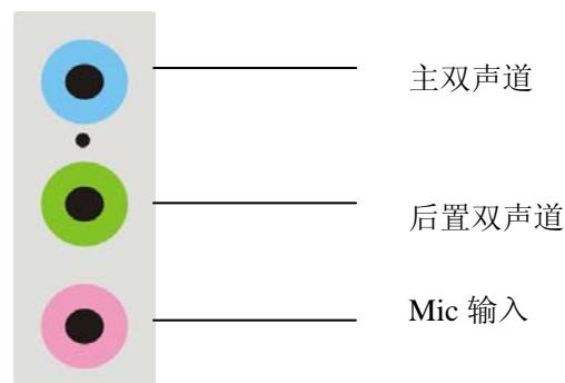
描述: 在 4 声道设置下 Line In 被转换成 Line Out 功能。
