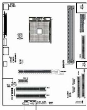
此处介绍的 3 个风扇接头在您的安装过程中扮演着重要的角色。它们是主板上所有降温风扇的电源供应接头，提供降低系统及 CPU 温度的重要功能。
