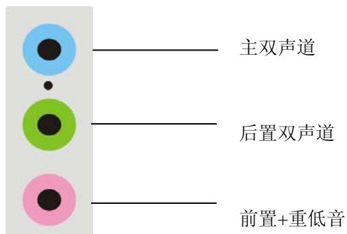
描述：在 6 声道设置下 Line In 和 MIC 都被转换成 Line Out 功能。
