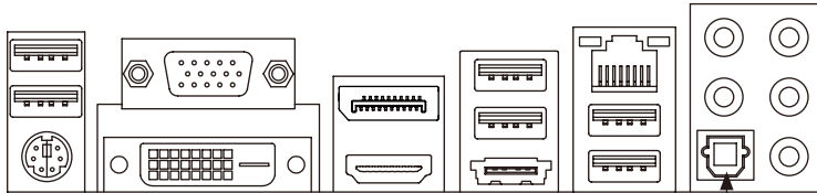
连接S/PDIF光纤输出线
