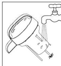
1. 机头：请用水轻轻洗去机头下部粘附的豆浆或其它粘附物，切勿将机头浸入水中，也不要用水清洗机头头部，以防止机头进水，发生短路现象。
