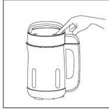
请将机头按正确的位置放入杯体中，插上电源线，功能指示灯全亮，按下“选择”键，选择所需的功能，对应指示灯亮，按“启动”键启动相应的制作程序。
