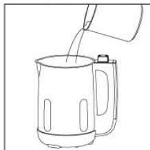
请将水加至上、下水位刻度线之间。（本机具有无水防干烧功能，如杯体内无水或水位过低，机器不工作，以保证使用安全。）
