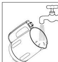
2. 杯体：请用清洁块仔细清洗杯体，将杯体底部以及侧面清洗干净，以免残留的豆浆产生异味。清洗时请勿将杯体浸入水中，请勿用水冲洗耦合器及底座，以防杯体或底座进水引起短路等安全问题。
