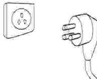
确保所接电源为安全接地电源，且当地电压与产品所标识的电压一致。
