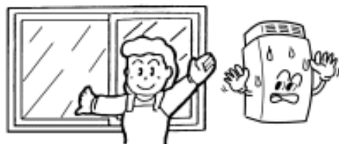
室内不得安装室外型热水器
