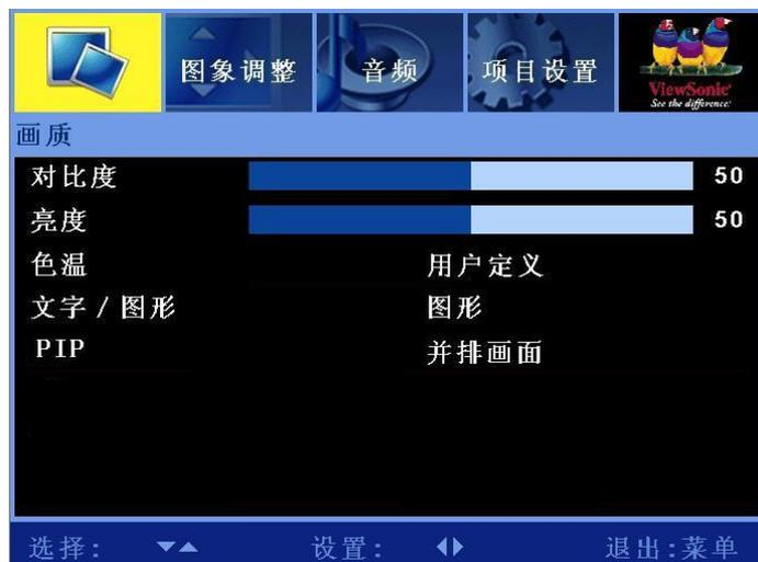
使用此屏幕配置色彩平衡、切换文字和图形显示、以及启用/禁用多画面显示功能。
