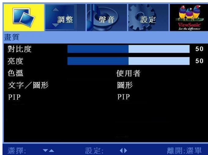
使用此螢幕來配置色彩平衡，切換文字和圖形顯示，啓用／停用多重畫面顯示功能。
