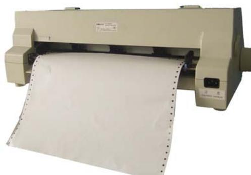
图 3-11 将连续纸安装在拖纸器链轮上
