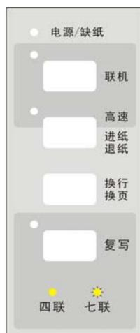
图 4-1 打印机控制面板
