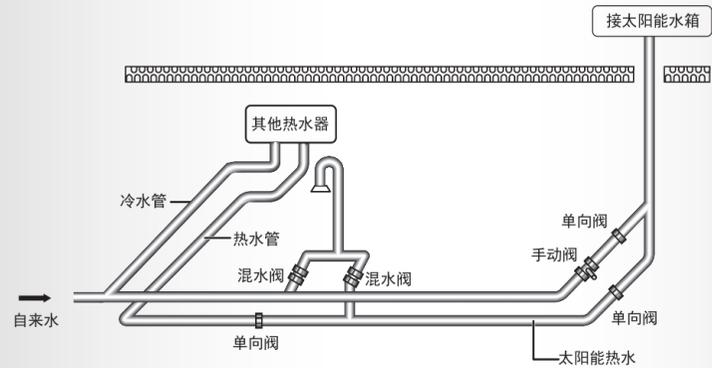
当太阳能热水器与其他热水器并存时, 冷热水管都要加装单向阀, 以防止由于其热水器箱内压力大, 通过热水管道把水倒灌到太阳能水箱中, 造成灾害。
