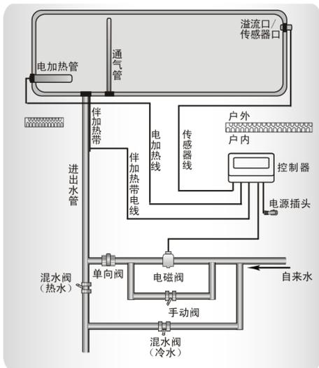
冬季寒冷地区, 室外管道应加装伴热带。否则当环境温度低于-5℃时, 任何形式的单纯保温均可导致管道冻结, 造成管道冻堵、损坏。
