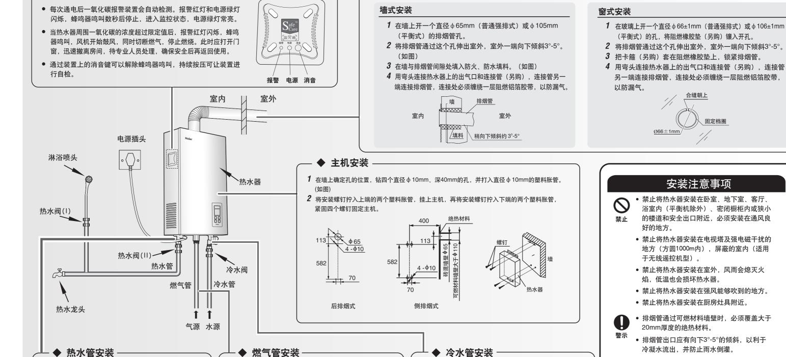
**1** 燃气接头规格为G3/4"管螺纹。
