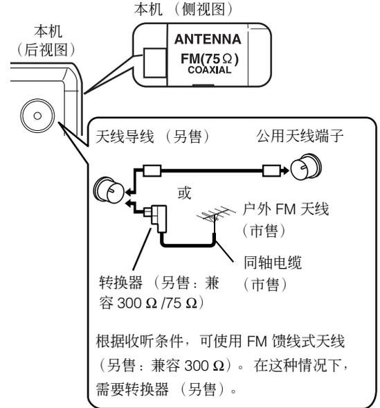
使用随机提供天线以外的天线时，请参阅天线和转换器的操作说明书，获取连接的详情。
