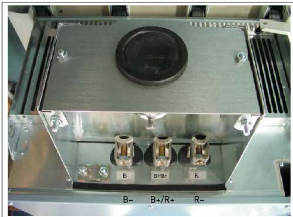
图 6-20. FR9 变频器的直流母线和制动电阻接线端子；直流母线端子标记为 B-/B+，制动电阻端子定义为 R+/R-
