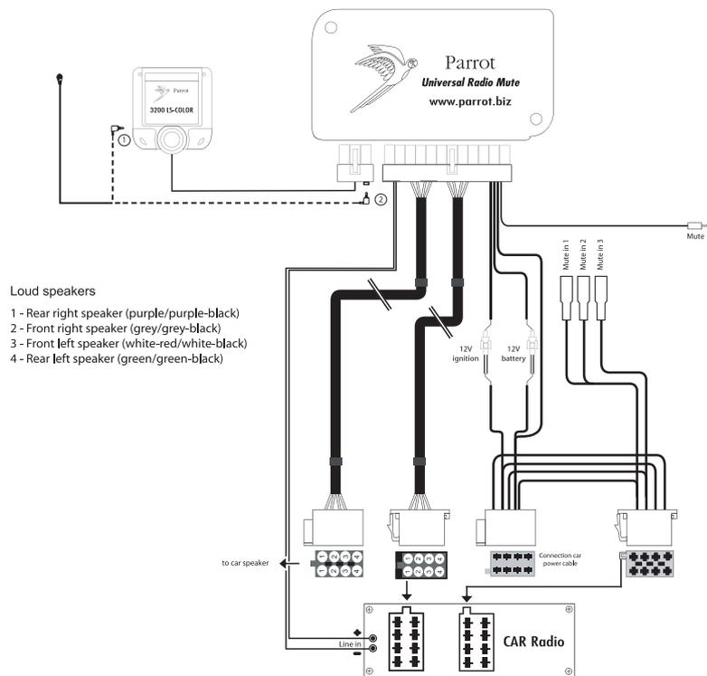
确定您能清晰的看到屏幕，同时不影响您开车时的视线。车载装置安装完毕后，打开电源，您可以调整屏幕光亮度和对比色。安装线自带ISO接口，同时附有一个接出口，您可以通过接出口直接连接汽车扩音器。
