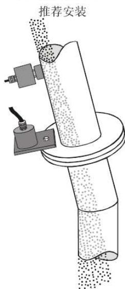
产品和管道的摩擦性好。将传感器安装于垫圈上游，以获取最大的声波强度。
