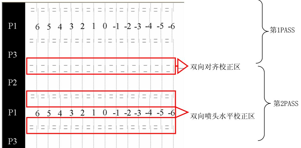
3) 上图所示打印的图样, 其中图示双向喷头水平校正区的上下两短线之间为同色两喷头打印叠加区域, 用于观察同色喷头间水平对齐状况 (参考 4.5 单向同色水平校正), 双向对齐校正区的上下两短线之间为前 PASS 与后 PASS 间水平对齐状况.
