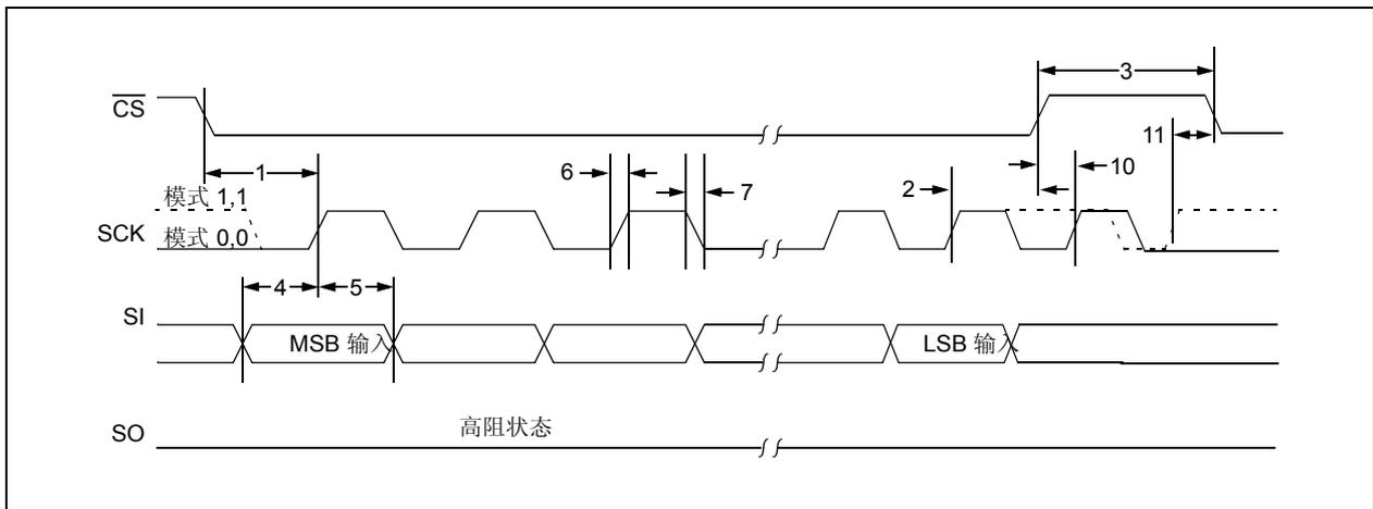
图 11-9: SPI 输出时序图
