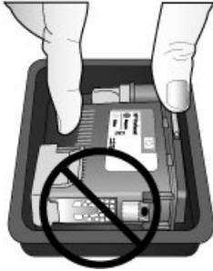
7. 从打印头上撕下桔黄色的保护封面并将其废弃。不要接触到打印头上的金色触点。
