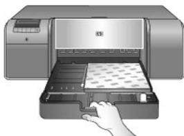
如果要展开或取下纸盒放入纸张，请捏住释放装置并推动主纸盒直到它抵住纸张末端，然后将其推入打印机使其完全卡住。**请确保首先调节主纸盒的长度并将其在打印机中复位，然后调节纸张长度导板和纸张宽度导轨，否则会出现卡纸。**
