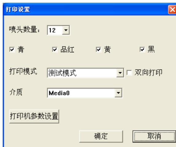
该功能用于设置打印机参数、选择打印模式、及单、双向打印方式、选择打印墨水的颜色以及介质类型。
