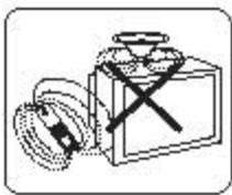
电视机应远离扬声器、电动机、变压器等感性物品，以防引起色彩异常。
