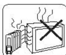
机内温度过高易引起电视机损坏，应保证电视机通风良好，如必须堵住电视机散热孔，电视机应远离热源(如：暖气、火炉等)先，并避免阳光直射。
