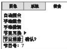
自动搜台过程中，可能会搜到一些假台或重复的节目，这时可利用节目清除功能，清除这些多余的台。按“菜单”键3次，进入“搜台”菜单，按“节目”键选择“节目号”项，用“音量”键选择要清除的台号，按“节目”键选择“节目清除”项，按“音量增”键光标右移，显示“确认？”，按“音量增”键进行清除，同时有字幕提示“请等待...”，操作完成，会显示“OK”字样，清除成功。
