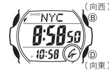
2. 所需要的城市代碼顯示後，按住 **A** 鈕約一秒鐘開啟（DST 指示符顯示）或解除（DST 指示符消失）夏令時間。
