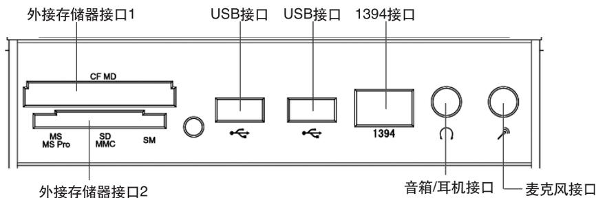
外接存储器接口 1: 能读写 CF 和 MD 存储卡数据
