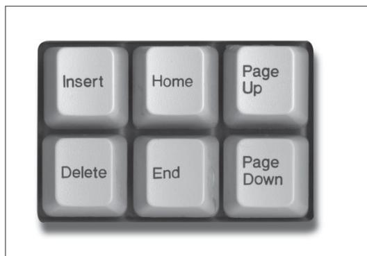
**Insert 插入键**：按该键可进入插入状态，输入的字符插入到光标所在位置，其余字符顺序右移。再按一次该键，可以取消插入状态。
