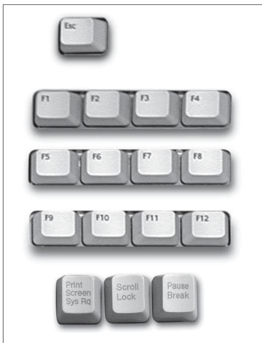
**Esc取消键**：常用于退出程序或中止某种操作。
