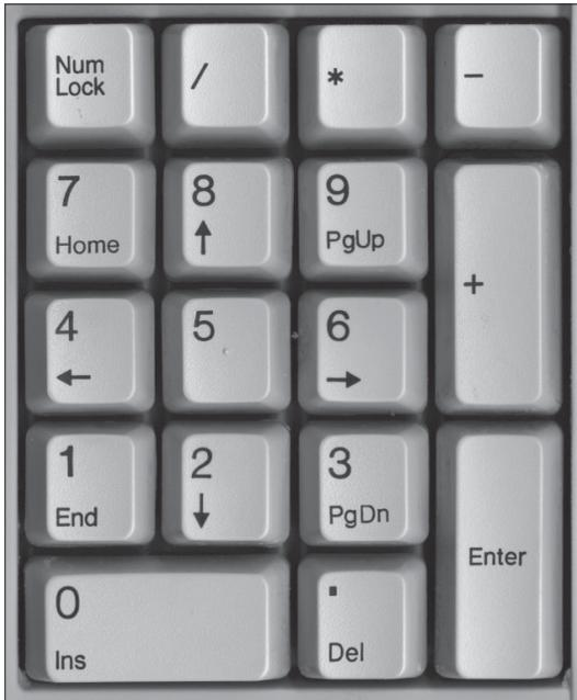
数字键区包括了 10 个数字键、加减乘除符号、小数点、**Num Lock** 键和回车键。当 **Num Lock** 键的灯亮时,数字键区的各个键作为数字键使用;灯不亮时,这些键作为编辑功能键使用。
