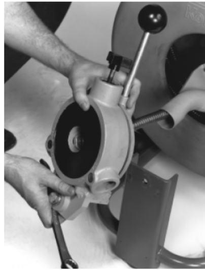
图7b — 用3/4" 拆下螺栓和自动进索机构
