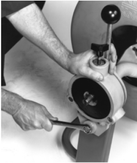
图7a — 用3/4" 拆下螺栓和自动进索机构
