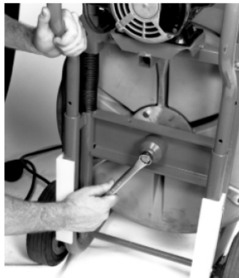
图9 — 拆下钢索鼓固定螺栓
