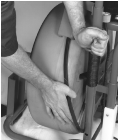
图8 — 松开皮带张紧装置
