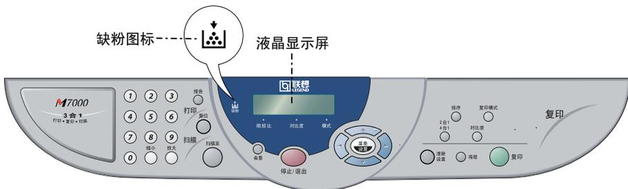
当缺粉指示灯亮且显示出**TONER EMPTY（墨粉用尽）**的消息时，则表明墨粉已用尽了。一旦出现此消息，打印机将不再打印，直到更换了新的墨粉盒。
