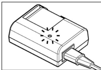
**3** 当充电提示灯转变为绿色后，即表示充电完成，可将电池取出及解除供电位连接。
