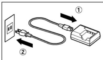
**1** 将电源线和充电器相连接，继而将插头与供电位连接。
