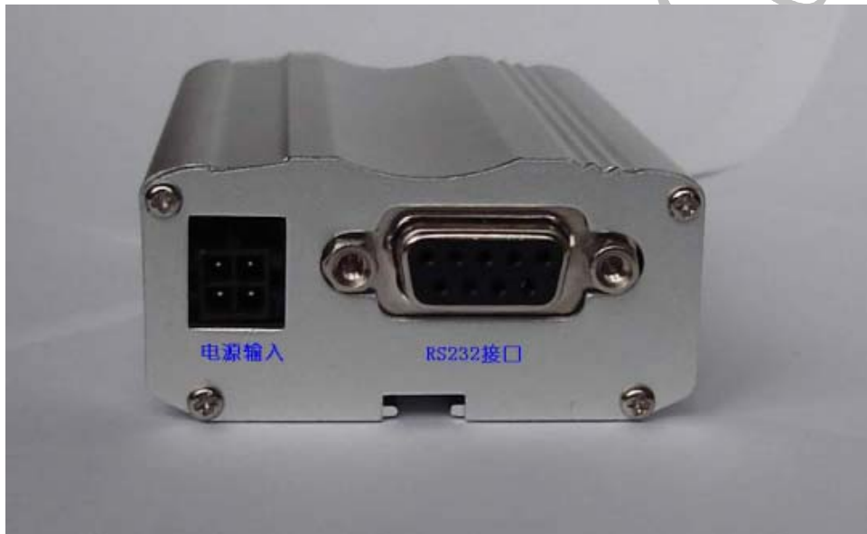
后视图：DC 直流电源输入，RS232 串行接口
