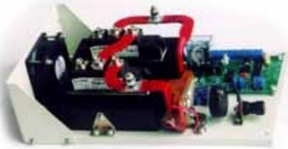
为满足负载供电要求，在电源与负载间加装 VR1 直流降压稳压器，是比较经济适用的办法。它随电源电压的增高串入降压二极管，电压降低时，又将其旁路实现负载稳压。现以使用 VR1-21 一级为例，其原理框图如图（一）所示。其调压级差为 3V，电源电压为 28V 时。C1 释放，Z1、Z2 串入，供给负载电压为 25V。
