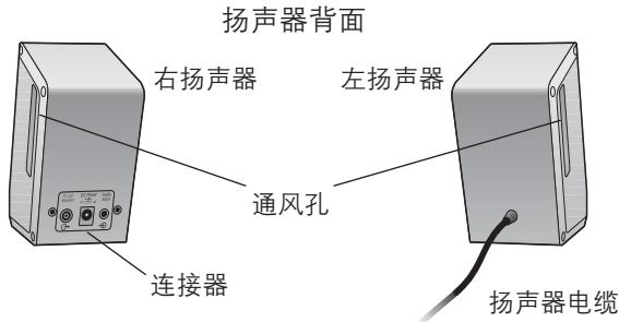
**⚠ 小心：**谨防将任何物体（如电缆、手指、铅笔或螺丝刀）插入各扬声器侧面的通风孔中。此类物体会损坏扬声器并降低其性能，并可能使质保失效。
