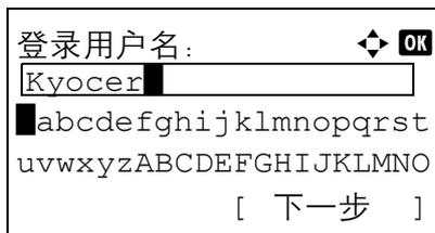
如果画面上显示字符面板，请使用光标键从显示的字符中选择所需的字符，然后按确定键输入该字符。
