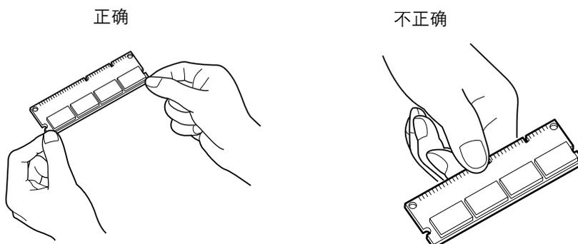
在处理内存模块之前，您需触摸水管（水龙头）或其他较大的金属物体释放身体内的静电以保护电子元件。或者，如果条件允许，应在安装内存模块时佩戴防静电腕带。
