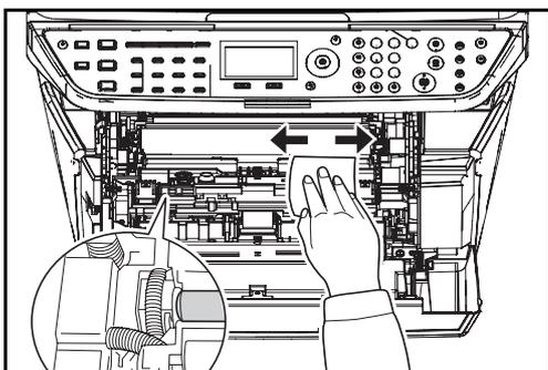
5 使用干净的无尘布清洁金属对位辊上的灰尘与污垢。
