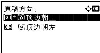
按**确定**键后, 请选择完成复印件的装订边以及原稿放置方向。
