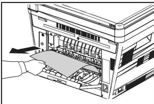
如果定影单元内部出现卡纸，请打开定影盖板，然后拉出卡住的纸张将其清除。
