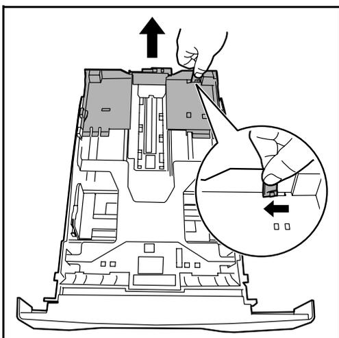
若要使用比 A4 尺寸更长的纸张，请通过逐个推动释放杆来拉出伸缩纸盒，然后将其调节至所需的纸张尺寸。
