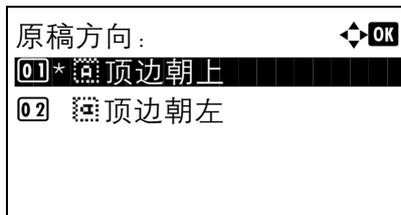
按**确定**键后, 请选择原稿和完成复印件的装订边以及原稿放置方向。
