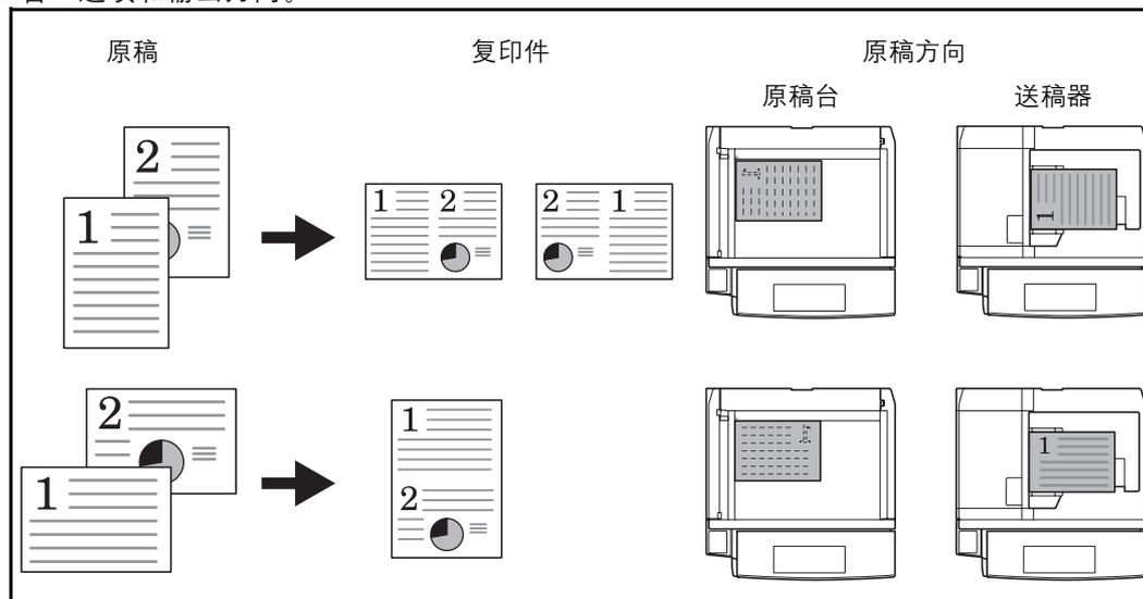
**注：**将原稿放置在原稿台上时，请务必按页面次序复印原稿。
