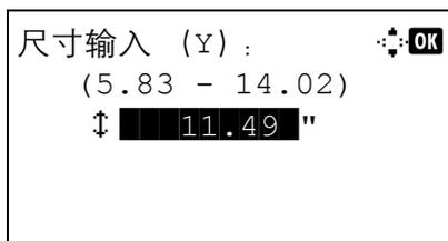
如果选择了 [ 尺寸输入 ], 您可以登录一个自定义尺寸。在显示的画面中, 使用数字键设定纸张的垂直尺寸 (Y) 和水平尺寸 (X)。
