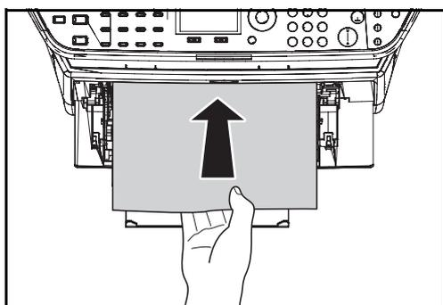
2 重新在手送纸盘中装纸。打开后再关闭上盖板以清除错误，然后机器会预热并恢复打印。
