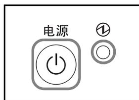
要进入睡眠模式，请按**电源键**。此时除主电源指示灯在内的所有指示灯及信息显示屏都会熄灭，以便最大限度地节省电力。此状态被称为睡眠模式。
