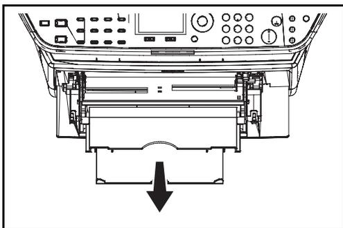
3 调节手送纸盘中纸张导板的位置。手送纸盘上标有标准纸张尺寸。选择标准纸张尺寸时，将纸张导板滑到相应的标记。
