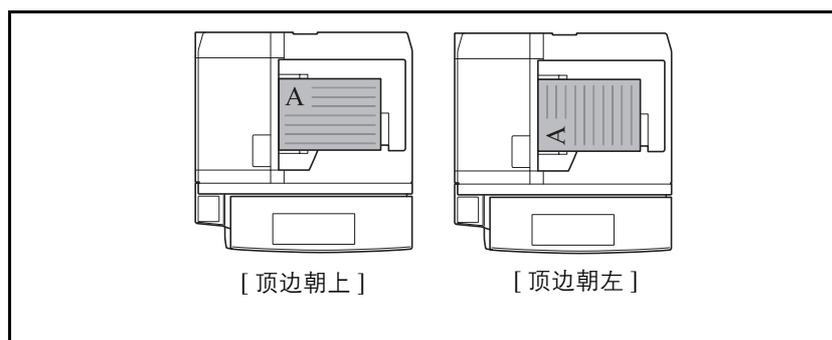
将原稿放在原稿台上准备发送时，请使用以下步骤选择方向。
