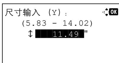
如果选择 [ 尺寸输入 ]，请使用数字键输入 Y（垂直方向）并按**确定**键，然后输入 X（水平方向）尺寸并按**确定**键。
