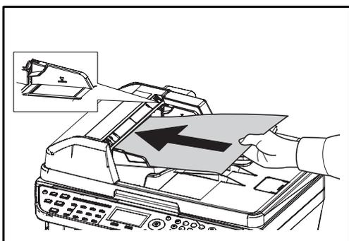
请确保装入的原稿高度没有超过指示的最大高度。超过指示的最大高度可能会造成原稿卡纸（参见插图）。
