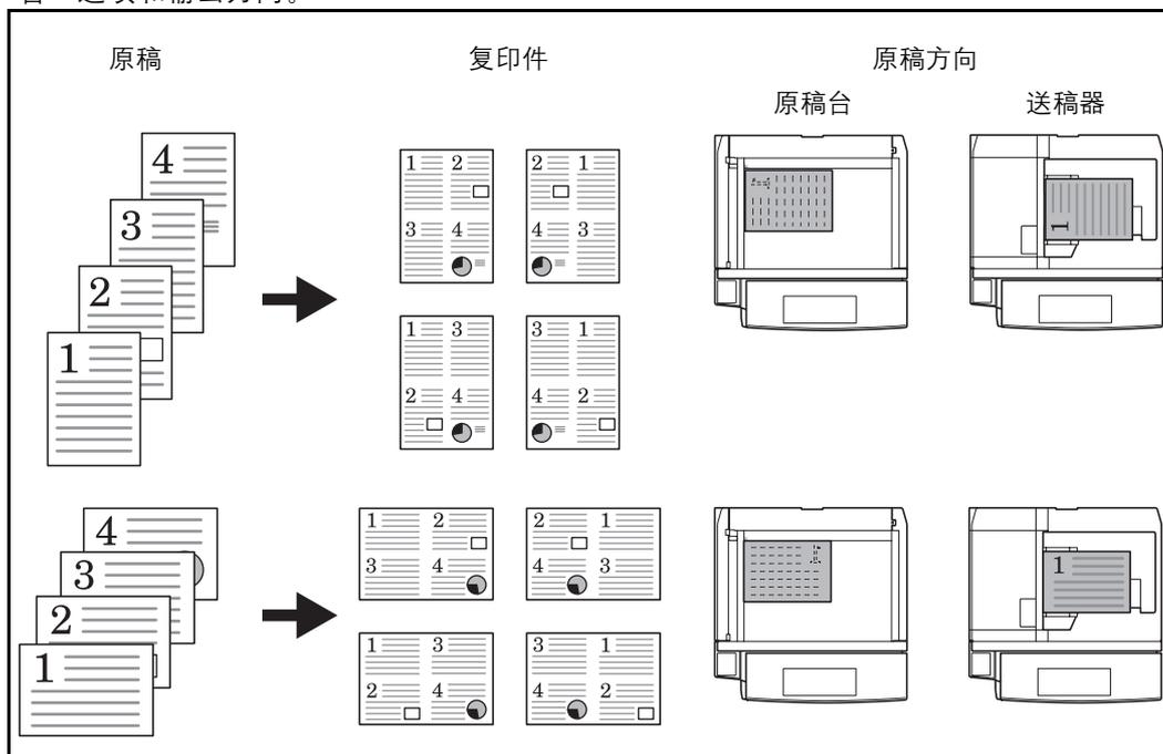
**注：**将原稿放置在原稿台上时，请务必按页面次序复印原稿。
