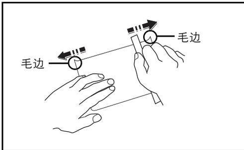
将明信片装入手送纸盘之前，请卷动明信片并且对齐各边。如果明信片弯曲，请将其抚平，然后再装入。在卷曲的明信片上打印可能会造成卡纸。
