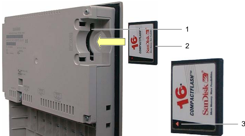
图索 5-4 将存储卡插入OP 170B
