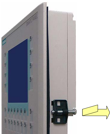
图 象 4-2 在OP 170B上插入弹簧端子
