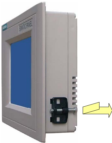
图 象 4-1 在TP 170micro、TP 170A和TP 170B上插入弹簧端子 四个弹簧接线端子都必须安装，并进行紧固。
