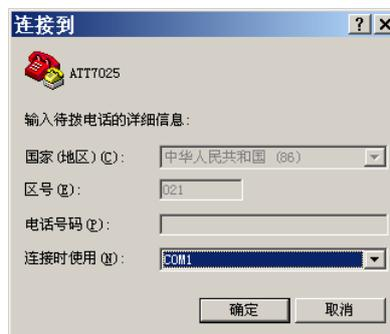
按确定后，选择 9600、8bit、无奇偶、1bitstop，数据流控制选择“无”（默认“硬件”）
