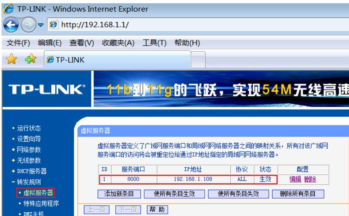
以上设置的含义是，当作为客户端的模块访问连接 PC 的路由器的外网 IP 地址时（这个地址由域名自动解析出来，用户不再关心它的变化），路由器自动会将该访问转接到连接在路由器上的 IP 地址为 192.168.1.108，端口为 8000 的 PC 上的 VCOMM 虚拟串口软件。
