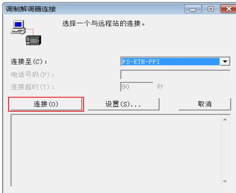
双击“刷新”去查找 PLC，一会儿即搜索到连接在网络的 PLC，选中需要操作的 PLC，接下来就可以进行程序数据的上载、下载和监控操作了。
