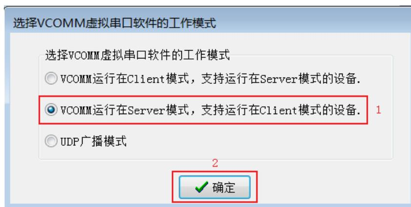
新增一个虚拟串口，要监听的 IP 地址=PC 的 IP 地址，Client 模式的设备尝试连接的端口=VCOMM 软件的端口，这里是 8000。
