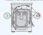
2 拆下包装螺栓并取出支撑块, 卸下防震槽型钢。
