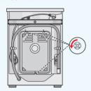
3 重新装好后背盖板,将固定 槽型钢的螺钉装回原位。用防 溅塑料堵将包装螺栓孔堵住。
