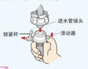
如果每周使用洗衣机一次以上,可不卸下进 水管接头,以免固定螺钉损伤。
