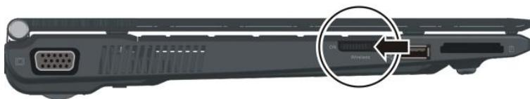
2. 按Fn+F1，开启无线网络功能，开启后无线局域网指示灯将会亮起 ( )。
