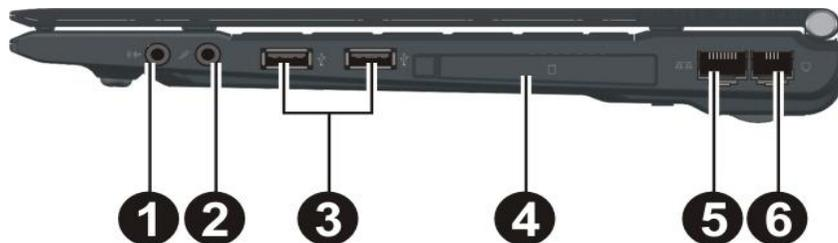
1. 音频输出接口 音频输出，可连接耳机、喇叭或扩音设备。
