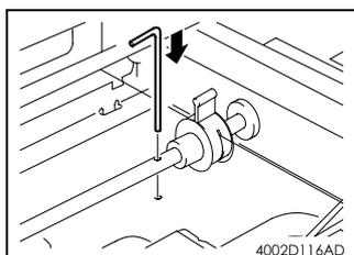
11. 将一个内六角螺钉用扳手插进转轴和 IR 基板的空内。
