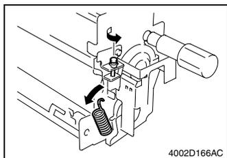
24. 旋松前辊压紧螺钉，脱开弹簧的上端。
