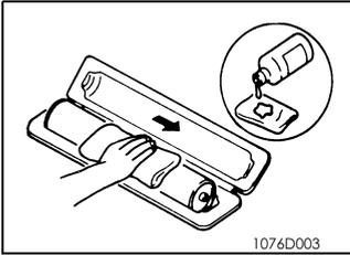
C. 将一个一折为四的，干净的，无灰尘未使用过的棉垫沾上一些乙醇。连续移动棉垫，从后端边缘到前端边缘后脱离表面，将 PC 感光鼓表面擦拭一到两次。
