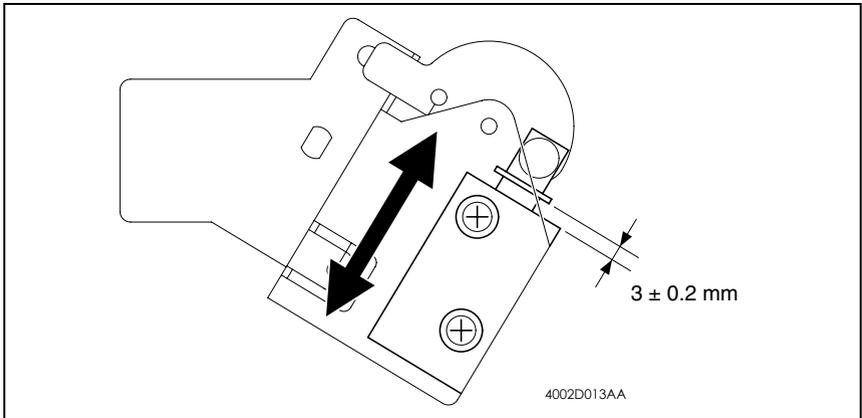
6. 完成调整后，旋紧 2 个固定切换电磁铁的螺钉。
