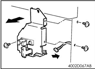
4. 卸下 3 个螺钉和纸盒设置感应器固定支架。
