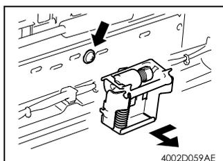
4. 松开一个螺钉，卸下纸张分离轮固定支架。
