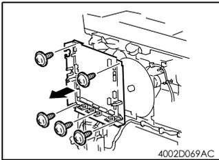
5. 卸下 5 个螺钉和主控板固定支架。
