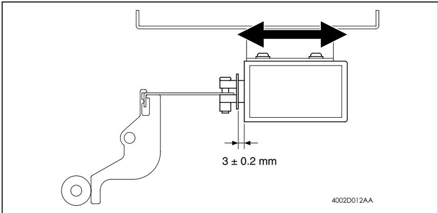
4. 完成调整后，请旋紧 2 个固定收缩电磁铁的螺钉。
