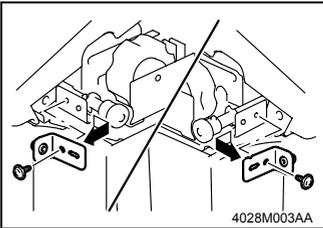
4. 卸下控制面板两侧的 2 个螺钉和固定支架。
