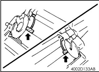
4. 使用刷子将随同清洁刮片一起付运的润滑剂涂抹在密封件的两侧。
