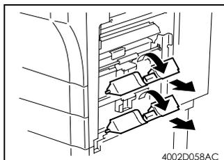
3. 按照箭头方向转动 90 度，卸下纸张分离轮 / 纸张导板组件。
