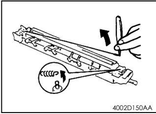
2. 首先卸下电极丝有弹簧的一端，然后卸下电极丝。
