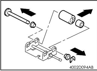
11. 卸下 E 形圈，卸下搓纸轮。
