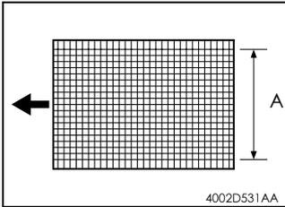
11. 在原稿测试页和副本上测量宽度 A, 计算出这两个测量值之间的差值。
