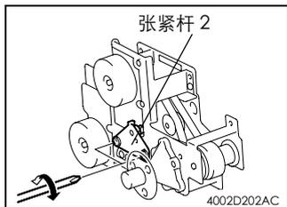
7. 旋松如左图所示的固定张紧杆 2 的螺钉，然后重新旋紧。
