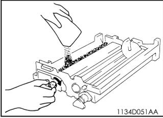
3. 转动搅拌辊，将新的显影剂均匀的倒入显影剂室内。
