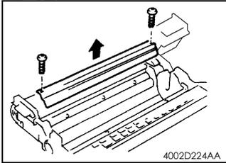
1. 拉出显影部件，卸下 PC 感光鼓充电电极和 PC 感光鼓。
