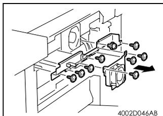
4. 卸下 3 个螺钉和 PH 冷却风扇马达固定支架。
