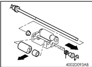
10. 卸下 E 形圈，卸下进纸轮。
