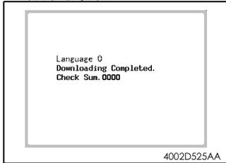
7. 检查触摸屏上的显示信息，是否指示重写正确。
