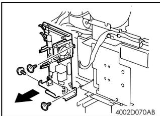
7. 卸下 3 个螺钉和电源板固定支架。
