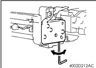
2. 当分离爪电磁铁处于断电位置时，请使用内六角螺钉扳手调整 3 个纸张分离爪的位置。
