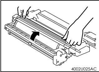
9. 用手顶住 PC 感光鼓的两端，按照箭头所示的方向将之转动半圈。
