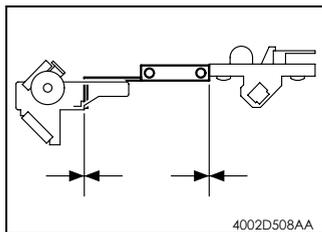
5. 将扫描器和第二 / 第三反光镜支架紧紧压在扫描器定位夹上。
