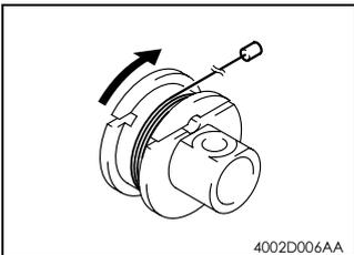
6. 从前向后，将线缆带滚珠的一端在滑轮上顺时针缠绕 5 圈。
