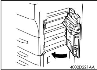
2. 轻轻地关闭右上门, 使设置感应器触发器不与机架接触。
