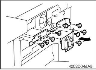
7. 卸下 3 个螺钉和 PH 冷却风扇马达固定支架。
