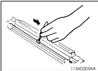
2. 使用镊子夹紧沾有酒精的软布，沿着一个方向轻轻擦拭纸张分离器电极丝。
