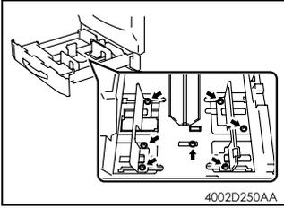
7. 拉出作为纸张来源的纸盒，旋松如左图所示的 7 个螺钉。
