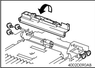
6. 卸下 5 个螺钉和电磁铁固定支架。
