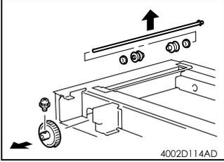
10. 卸下扫描器驱动齿轮，前部和后部的滑轮、衬套和转轴。
