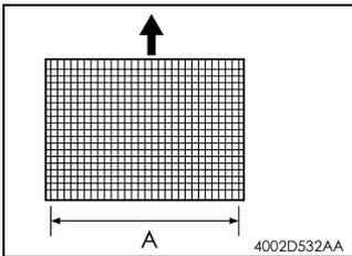
11. 在原稿测试页和副本上测量宽度 A, 计算出这两个测量值之间的差值。如果存在差值, 请执行如下调整步骤。
