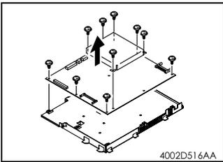
20. 卸下 10 个螺钉和图像处理板。
