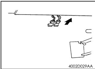
5. 从吸气部件的底端拔下两个插头。
