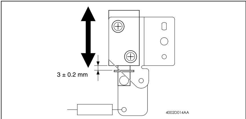
4. 完成调整之后，旋紧 2 个固定切换电磁铁的螺钉。
