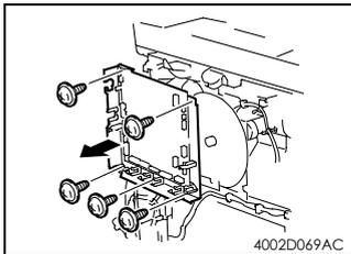
6. 卸下 5 个螺钉和主控板固定支架。
