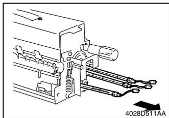
13. 从前部拉出上定影辊加热灯，定影辊副加热灯和下定影辊加热灯。
