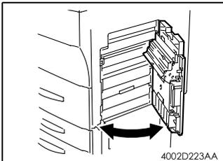
4. 打开并关闭右上门 2 至 3 次, 确保右上门设置感应器的开关不与机架接触。
