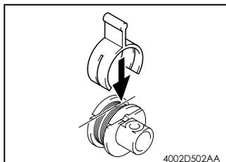
8. 将线缆定位夹滑入滑轮，并将线缆定位。
