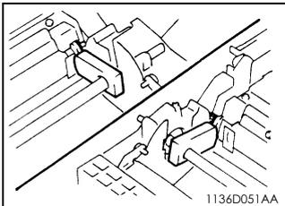
4. 在显影部件内装上套管 / 磁辊定位夹。
