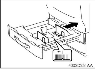
8. 观察纸盒内调整板上的标尺，移动边缘导板。
