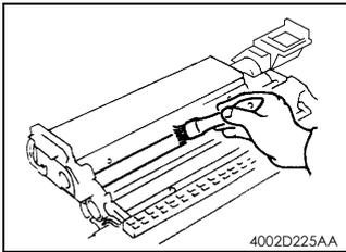
3. 使用刷子，将套管表面的显影剂刷干净。
