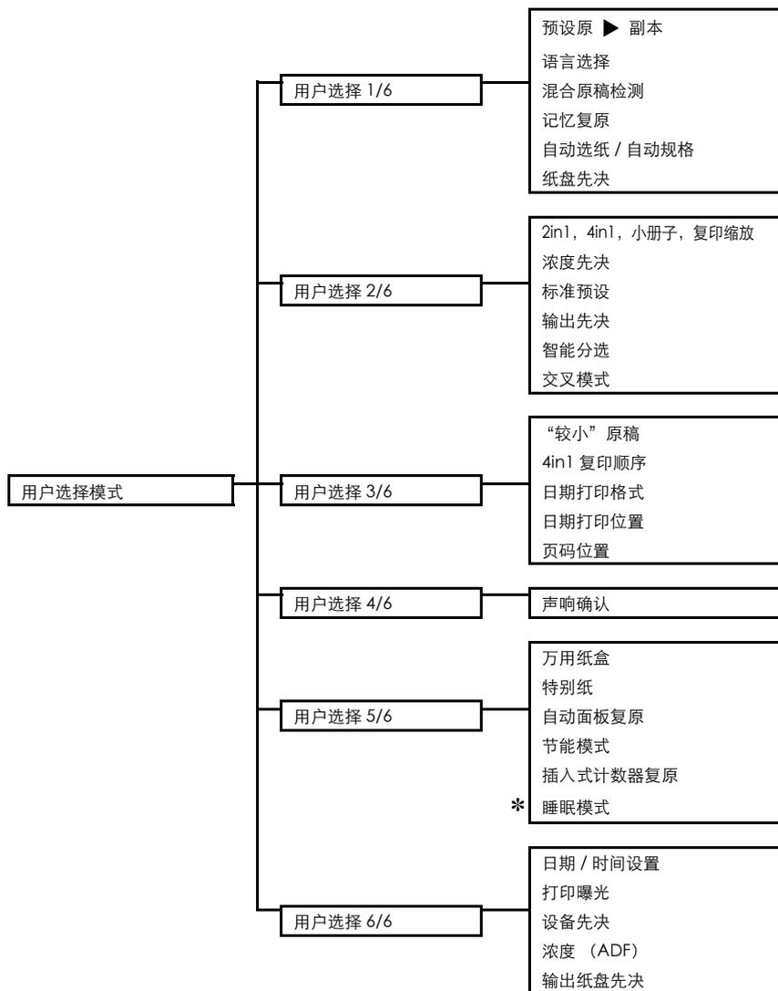
\* 当一个打印机控制器与主机相连时，触摸屏上显示的功能说明是“睡眠模式禁用”，当未连接时，显示的是“自动关闭禁用”。
