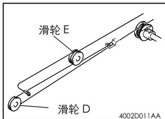
18. 将线缆带弯钩的一端缠绕在滑轮 D 和滑轮 E 上。
