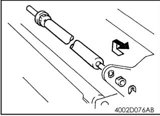
14. 卸下 E 形圈，从上同步辊前端卸下衬套。
