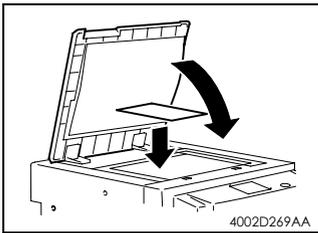
9. 将测试页放置在原稿玻璃上, 并放下原稿盖板。
