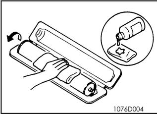
D. 使用棉垫的同一面，重复如上说明的第 3 步骤地后半部分，直到 PC 感光鼓的所有表面清洁干净为止。擦拭时必须使各次擦拭的区域重叠。正确的清洁需要将 PC 感光鼓完整的旋转两周。
