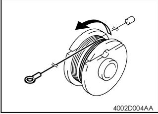
3. 从前向后，将线缆带弯钩的一端在滑轮上逆时针缠绕 5 圈。
