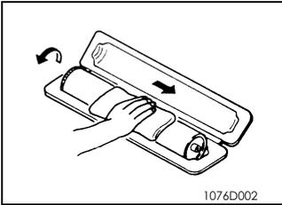
B. 使用一块干的，无灰尘的干净棉垫轻轻擦除 PC 感光鼓表面残留的碳粉。
