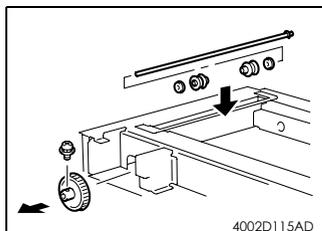
9. 将前部，后部滑轮和衬套安装在转轴上，然后将转轴安装在 IR 部件上。
