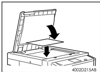
11. 将 A3 或者 11 × 17 尺寸的纸张放置在原稿玻璃上，并放下原稿盖板。
