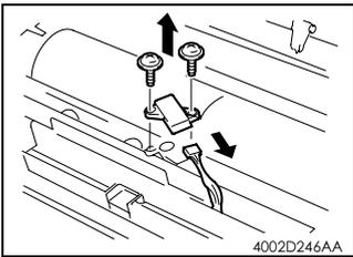
8. 卸下 2 个螺钉，拔下插头，卸下 AIDC 感应器。
