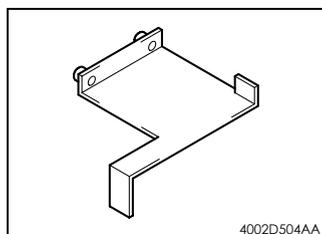
5. 套筒 / 磁辊定位夹具
