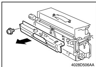
18. 卸下 1 个螺钉和线束导向板。
