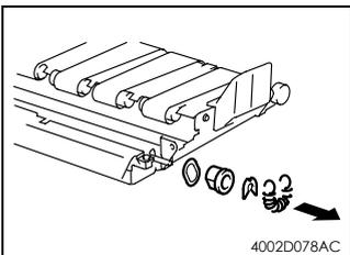
3. 将弹簧脱开，卸下 E 形圈，从下同步辊后端卸下齿轮和衬套。
