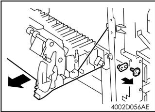
8. 卸下一个螺钉和支撑架。
