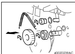
11. 卸下 E 形圈，卸下齿轮。
