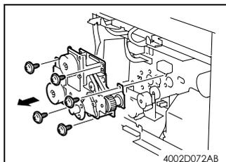
9. 拔下 2 个插头，卸下 5 个螺钉和显影部件驱动组件。
