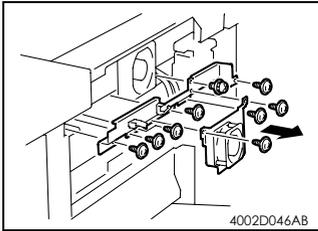
11. 卸下 3 个螺钉和 PH 冷却风扇马达固定支架。
