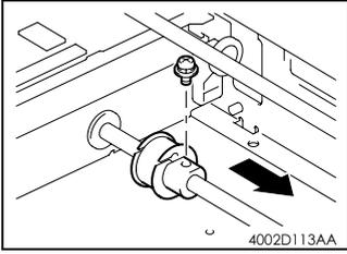
9. 卸下 1 个螺钉，将后部滑轮和衬套滑到前部。
