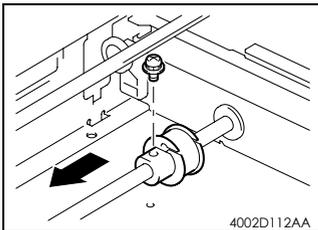
8. 卸下 1 个螺钉，将前部滑轮和衬套滑到后部。
