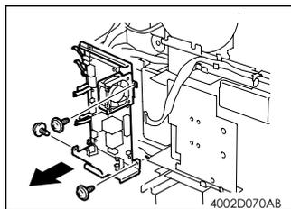
8. 卸下 3 个螺钉和电源板固定支架。
