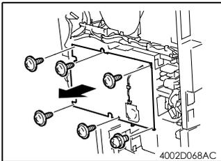
6. 卸下 6 个螺钉和主控板盖板。
