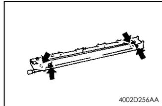
分离爪电磁铁上的 2 个螺钉
