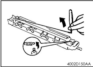
3. 首先卸下电极丝有弹簧的一端，然后卸下电极丝。
