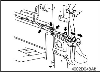
10. 拔下 2 个继电器插头，从线束夹上拆下线束。
