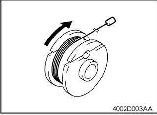
2. 从后向前，将线缆带滚珠的一端在滑轮上顺时针缠绕 5 圈。
