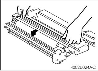
8. 用手顶住 PC 感光鼓的两端，按照箭头所示的方向将之转动半圈。
