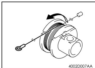
7. 从后向前，将线缆带弯钩的一端在滑轮上逆时针缠绕 5 圈。
