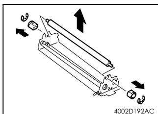
4. 从前端和后端卸下 E 形圈和衬套，卸下清洁纸压紧辊。
