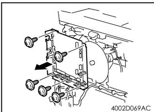
14. 卸下 5 个螺钉和主控板固定支架。
