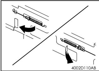
5. 将前部和后部的扫描器驱动线缆弹簧在钩端脱开。
