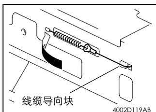
16. 将线缆带弯钩的一端装在线缆导向块的槽内，并挂上弹簧。
