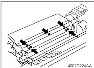
5. 旋松 3 个固定限粉板的螺钉。将 D.B. 调整夹具安装在限粉板和套管之间。
