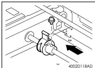
13. 将后部滑轮和衬套滑到后部，并使用 1 个固定螺钉固定。
