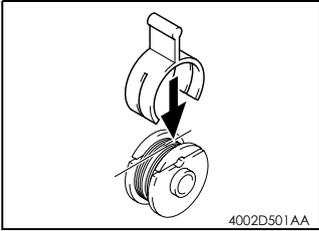
4. 将线缆定位夹滑入滑轮，使线缆定位。
