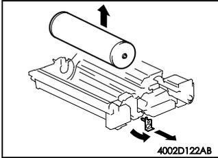
3. 旋松 PC 感光鼓挡块的 2 个螺钉，卸下 PC 感光鼓挡块。
