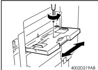
8. 旋松图示位置的固定多张手动送纸盘的 2 个螺钉, 按照需要移动多张手动送纸盘。
