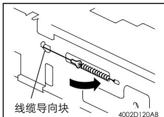
19. 将线缆带弯钩的一端装在线缆导向块的槽内，并挂上弹簧。
