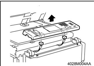
5. 拔出插头卸下控制面板。
