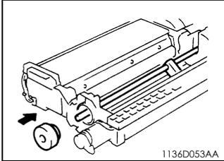
1. 将 PC 感光鼓纸张分离爪定位夹安装在显影部件上。
