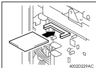
3. 将存储卡插在主控板上。
