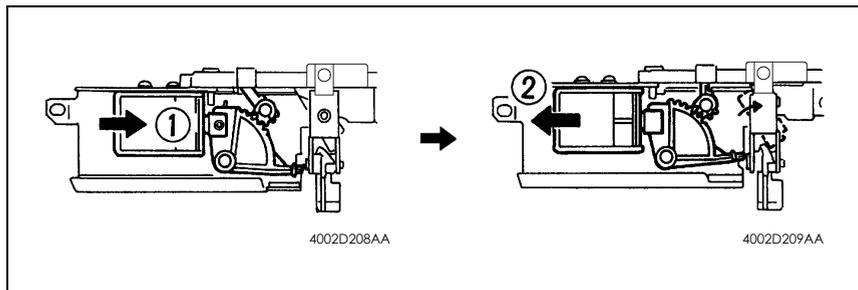
7. 完成调整后，旋紧 2 个搓纸电磁铁固定螺钉。
