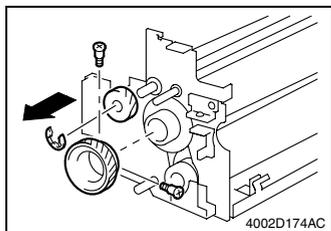
30. 卸下 E 形圈，2 个带肩螺钉和 2 个齿轮。
