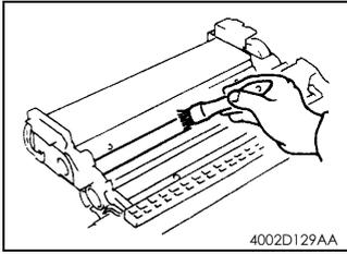
1. 使用刷子，将显影剂防扩散板上的灰尘刷干净。
