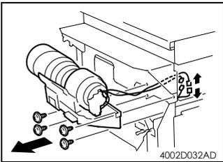
3. 拔下 2 个插头，卸下 4 个螺钉和主加粉仓。
