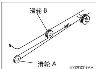
15. 将线缆带弯钩的一端缠绕在滑轮 A 和滑轮 B 上。
