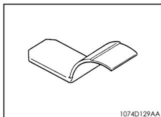
7. PC 感光鼓纸张分离爪定位夹具
