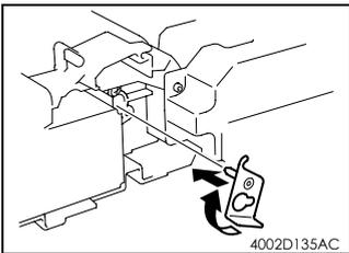
6. 安装 PC 感光鼓挡块，旋紧螺钉。
