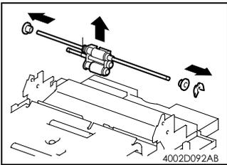
9. 卸下 E 形圈，卸下搓纸轮组件。
