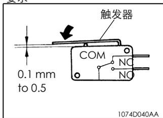
在触发器闭合时，开关和触发器之间的间距应为 0.1 到 0.5mm。
