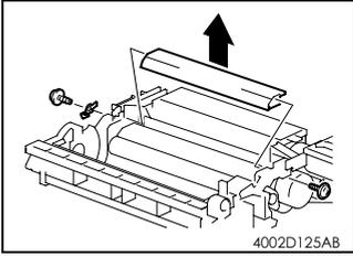
6. 卸下 2 个螺钉，挡块和显影剂显影剂防扩散板。
