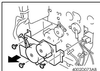
10. 卸下 3 个螺钉和传送 / 同步辊驱动组件。
