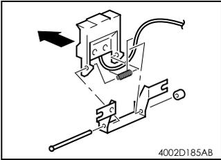
5. 卸下橡皮挡块，拉出转轴。
