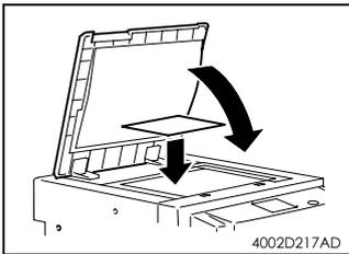
9. 将测试页放置于原稿玻璃上, 并放下原稿盖板。
