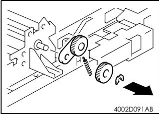
7. 卸下 E 形圈，卸下齿轮。
