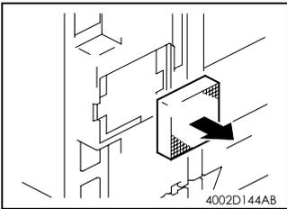
1. 脱开压片，卸下过滤器盖板。
