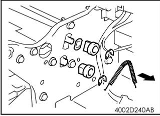
15. 脱开弹簧，卸下 E 形圈。从上传送辊和下传送辊的前端卸下衬套。
