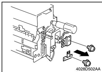
8. 卸下前部的上下灯管固定夹各一个螺钉，拆下这 2 个固定夹。
