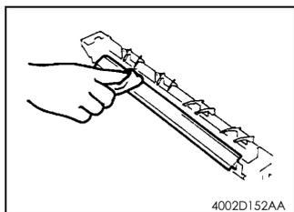
1. 使用沾有酒精的软布将影像预转印导板擦拭干净。
