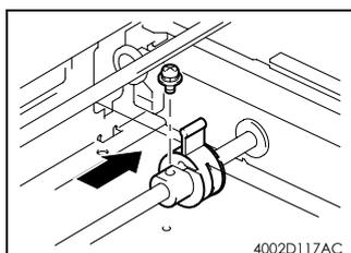
12. 将前部滑轮和衬套滑到前部，并装上 1 个固定螺钉。
