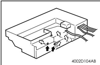
影像转印 / 纸张分离器电晕罩上的 4 个螺钉
