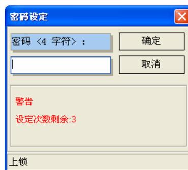
2. 若使用者忘记 DVP-SA/SC/SX 系列 PLC 机种的密码，请拆下电池等待 10 分钟后，PLC 程序与密码将被清除。或开启 ISPSOft，点选「PLC 主机」里的「PLC 程序内存设定」，清除 PLC 内存(回复出厂设定)。
