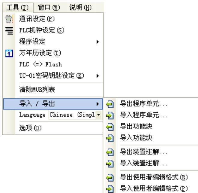
**通讯设定(P)** ⇨ ISPSOft 侦测计算机上可用的通讯端口, 让使用者选择一个可与 PLC 连接的通讯端口使用。
