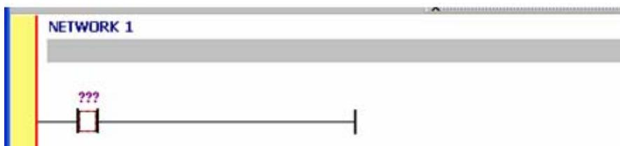
在阶梯图上产生一个开关装置
