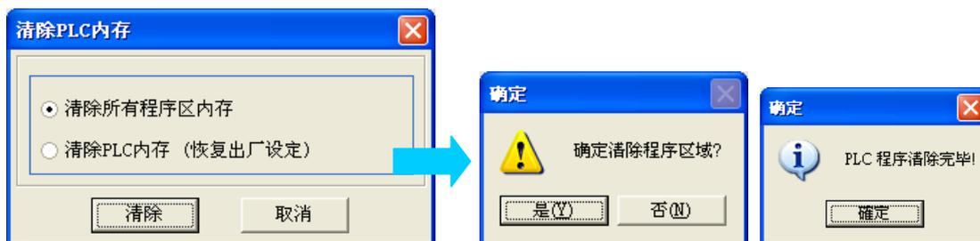
3. 若使用者选择「清除 PLC 内存 (回复出厂设定)」, 则程序内存和所有相关数据, 包括万年历将被清除。初始设定完成后, 请将 PLC 重新开机。
