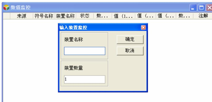
步骤 3: 指定欲监控的装置。例如, 若使用者欲监控 D1000 至 D1004, 则在「装置名称」字段输入 D1000, 「装置数量」字段输入 5。
