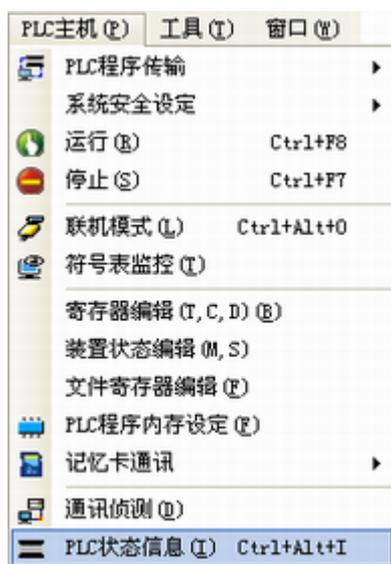
2. 显示 PLC 信息窗口，内容包括 PLC 内部软体信息、扫描时间、主机状态、输入 / 出点等信息。
