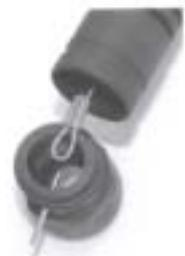
確認接頭正確後，將插梢穿過鋼索的套環中間，再將插梢完全固定。**注意，務必使用正確長度的插梢。**正確的插梢能固定住鋼索而且又不會超過接頭的外緣，接著再將接頭與蛇管接合處固定。我們建議您以防寒衣的貼合膠塗抹於接頭與蛇管的接觸面，再將接頭裝入蛇管。確認滑套螺帽的位置正確而且蛇管並未緊緊頂著螺帽，以免影響它的轉動。以束帶固定住蛇管即完成組裝。
