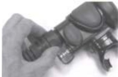
用手將滑套螺帽鎖上 SS1 的螺牙，即可加以組裝。記得將螺帽確實鎖緊以免意外鬆脫，但也不能過度鎖緊，以免傷及螺牙。
