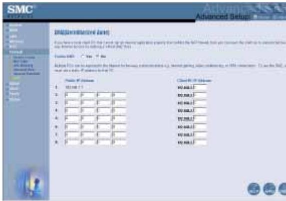
当您的计算机无法在防火墙后访问特定的 Internet 服务时，您可以为那台计算机开启自由的 Internet 访问服务。在这个界面中输入 DMZ 的 IP 地址。添加 PC 到 DMZ，可能会使您的计算机遭到一些安全上的攻击，所以请谨慎使用此功能。
