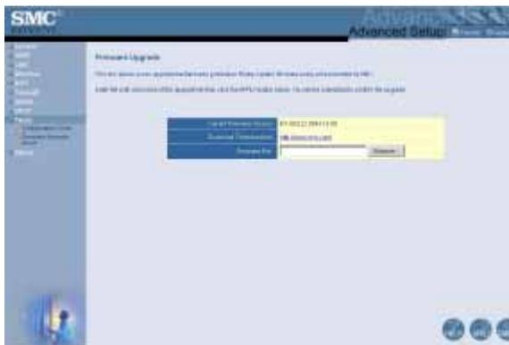
在这个界面中，升级无线宽带路由器的固件或用户界面到最新版本。从SMC的中文官方网址[www.smc-prc.com](http://www.smc-prc.com)上下载最新的固件，并保存到您的硬盘。在“Firmware File Field”，点击“Browse”选定所下载的文件，点击“Apply”。是否升级成功可以从Status页的Information信息栏确定。
