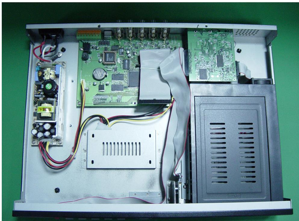
4. 先設定好在副硬碟(Slave), 再將硬碟橫放, 並將硬碟的電源端和排線端接好, 並朝向硬碟抽取盒, 並由機器的下方四個孔鎖緊硬碟, 螺絲附在附件包
