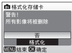
当插入存储卡时有两个格式化选项：**高速格式化**（仅格式化存储卡上用来储存数据的区域）和**格式化**（格式化整个存储卡）。电池电量低时无法进行**格式化**。
