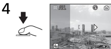
对下一张要与前一张照片重叠的照片进行构图，然后拍第二张。重复拍摄，直到拍完整套照片。
