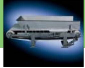
西门子称重给料机是自动化生产中连续在线称重和给料过程不可分割的一部分。高度灵敏的传感器提供高精度称重、提高混料连续性、可计量性和记录可跟踪性。自动化生产依靠这些重型给料机提供快捷、可靠和不间断的服务。西门子称重给料机这种不需维护的结构有着无可比拟的优越性能。其标准配置包括皮带称架、速度传感器和积分仪。所有给料机均有带凸缘的皮带，凸缘高度视其型号和具体应用情况而定。皮带的尺寸和宽度与应用情况相匹配。
