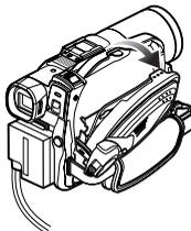
③ 将在圆形 DVD 托盘上的光盘正确插入到光盘舱内，直到它停止，然后关闭光盘插入舱盖。
