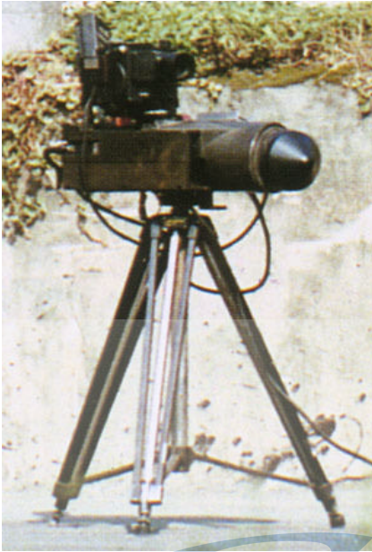
瑞製 MULTANOVA 6F Ka 頻雷達系統
